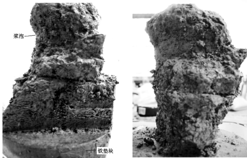
图 8 试样纵剖面图(注浆压力 0.5 MPa, W/C=1.2)
