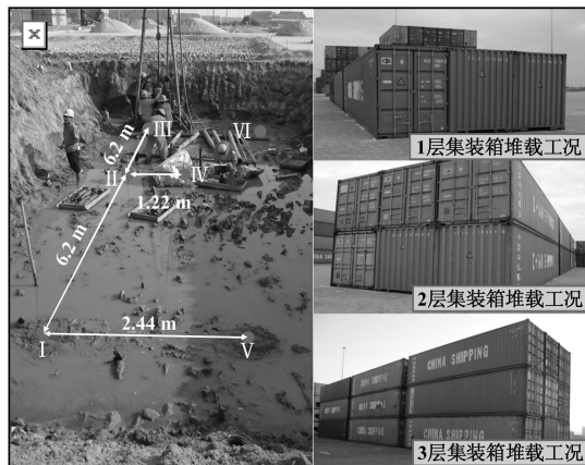
(b) 现场土压力盒布置及集装箱堆载试验图
