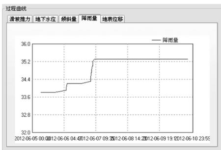
图 9 降雨量监测数据及图形显示
