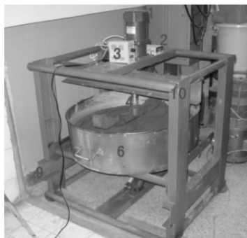
1-电动机, 2-电流表, 3-电动机变速器, 4-传动轴, 5-搅拌叶片, 6-搅拌桶, 7-底座, 8-升降架, 9-底座轨道, 10-支架
