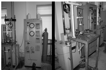
图 1 自制应力控制式三轴仪
