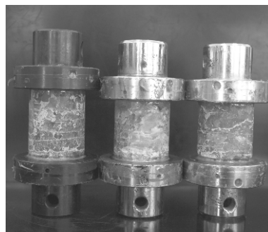
(b) 盐岩直接拉伸试件
