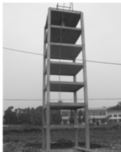
图 1 土 - 桩 - 结构模型
