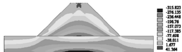
图 14 某路堤失稳时小主应力等值云
