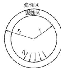
图 2 有裂缝区围岩弹性抗力计算简图
