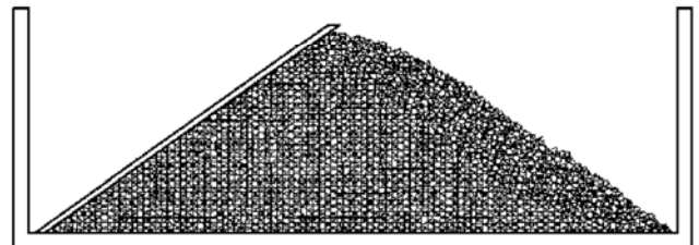
图 12 面板坝 16000 步时坝体构形
