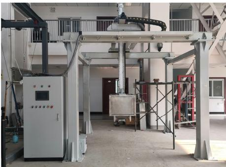
图 1 自动落雨装置
