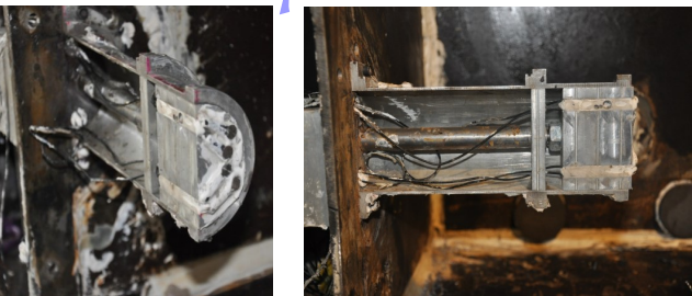
图 2 盾构模型立面及掌子面压力计布置
