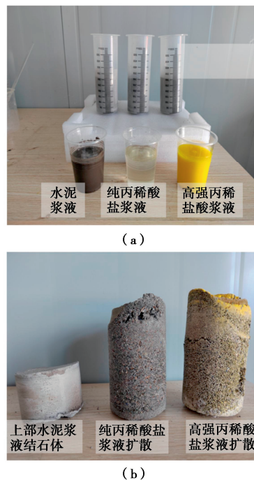
图8 不同浆液及其在碎粉岩中的渗透扩散效果
