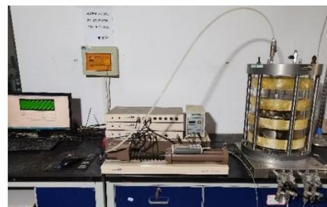
图 2 共振柱试验仪
