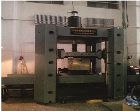
大型多功能接触面试验仪
