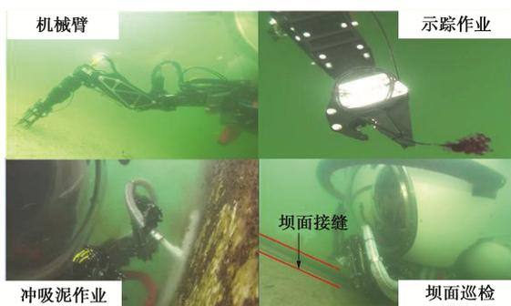
图 34 大坝深水检测修补“禹龙号”潜水器与加固平台示范应用
