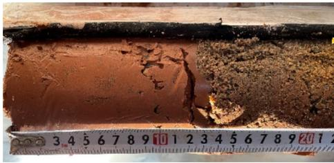
图 7 注浆扩散范围测量示意
