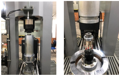
图2 TZW-3000II 岩石真三轴流变试验机
