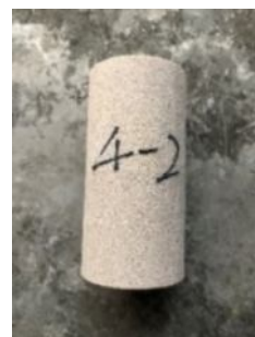
图 1 砂岩冻融试验试块
