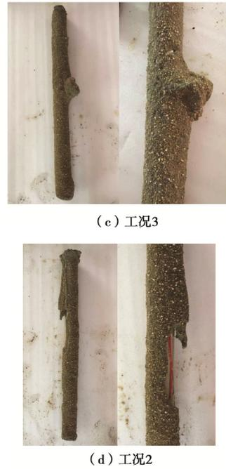
图 7 注浆结石体及其三维扫描点云云图
