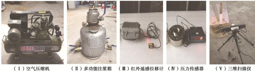
(b) 大直径随钻跟管桩桩侧注浆及承载性能测试物理模型试验系统实物图
