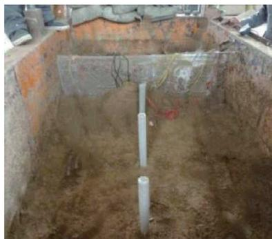
图4 模型试验桩位布置图
