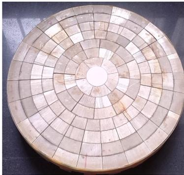
图3 岩土工程三轴试验微摩擦荷载传力板实物照片
