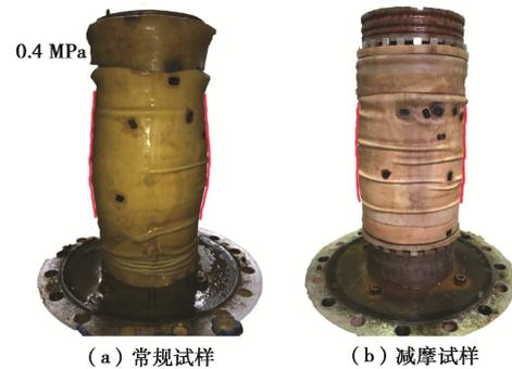
图10 试验结束后试样变形形态对比 ( $\sigma_3=400 \text{ kPa}$ )
