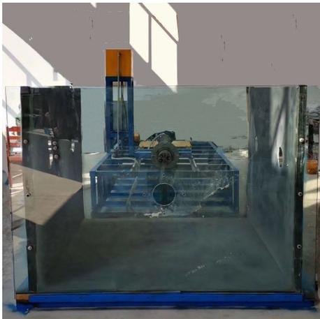
图 2 泥水盾构室内模拟试验装置
