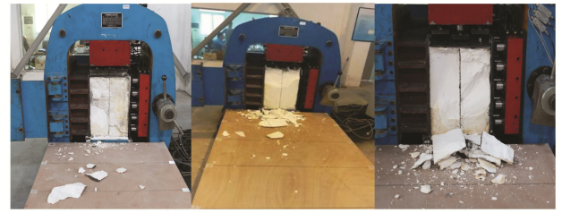
(a) 加载路径 I 下 (b) 加载路径 II 下 (c) 加载路径 III 下 图 5 试件在不同加载路径下的岩爆宏观破坏图
