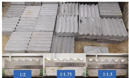
图 6 加工后的岩石试件
