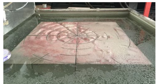
图 15 射流切割后钢筋混凝土状态
