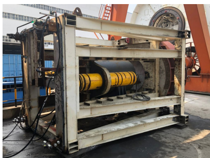
图 13 小型盾构机试验平台
