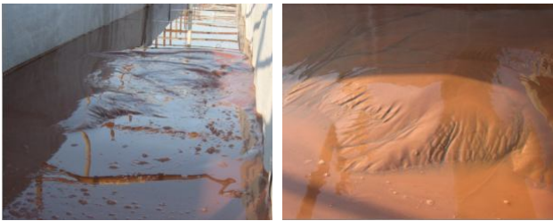
图3 尾矿流槽中的非均匀流态
