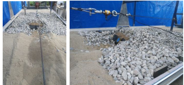
图 7 锚由砂土进入不同平均粒径的碎石层中
