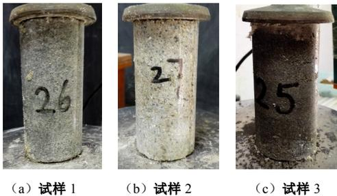
图10 钙镁固化砂柱
