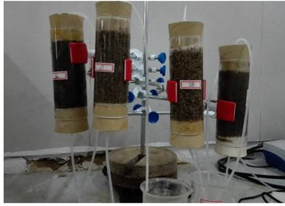
图9 砂土固化示意图
