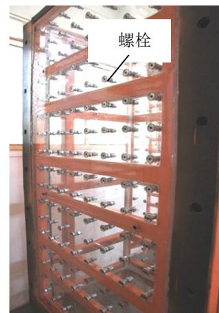
图 3 水箱连接土箱侧面
