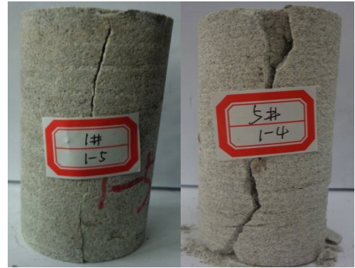
图5 岩样的标准轴向张拉破坏形式
