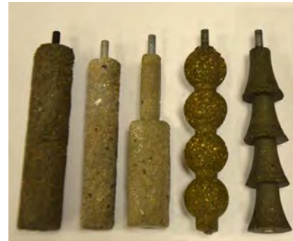
(a) 试验用锚杆锚固段
