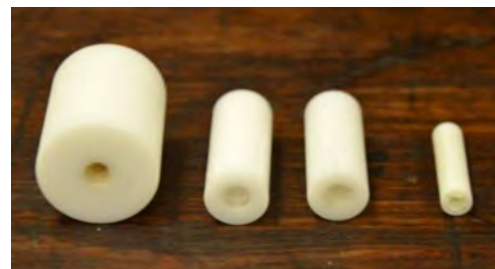
(c) 模拟试验锚杆自由段塑料套管
