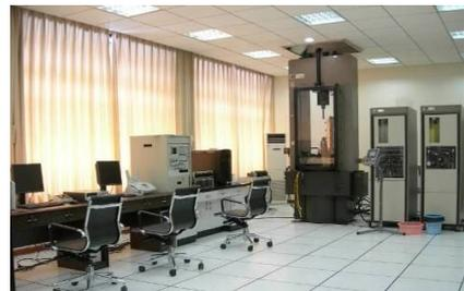
图 2 MTS 815 Flex Test GT 岩石力学试验系统
