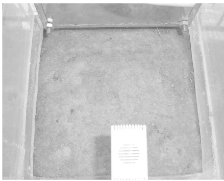
图 11 试验 20 d 试样土柱顶面照片 (K938)
