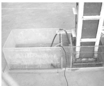
图 3 恒水位循环供水系统
