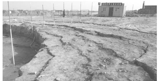
图7 裂缝逐级发展形成的台阶状地面形态
